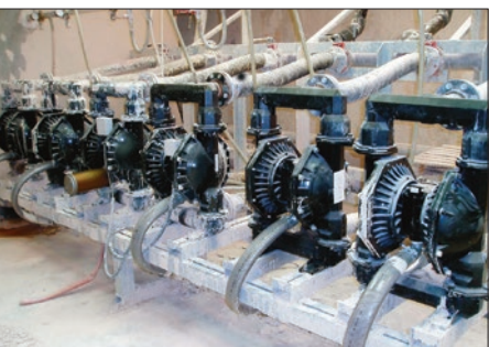
Bombas de diafragma de 3" montadas em uma plataforma para transferir a argila na fabricação de cerâmica
