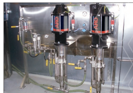
Bombas de extrusão proporção 23:1, usadas em uma plataforma multicomponente para transferir silicone
