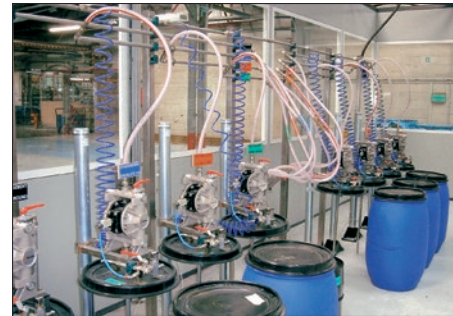
Bombas de diafragma de 1/2" instaladas em um processo de coloração
