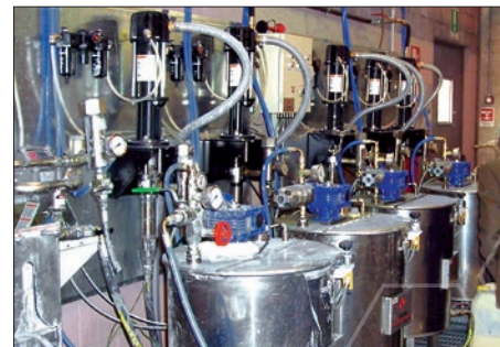
Bombas de pistão de 2 esferas, proporção de 11:1, usadas em um sistema de circulação de pintura
