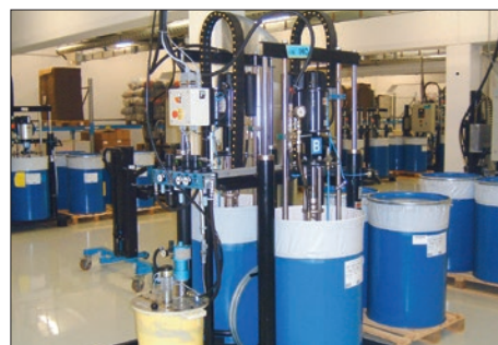
Bombas de extrusão proporção 23:1, usadas em uma plataforma multicomponente para transferir silicone
