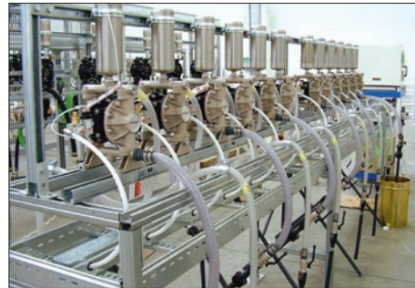
Bombas de diafragma de 1/2" montadas em um sistema de formulação de tinta
