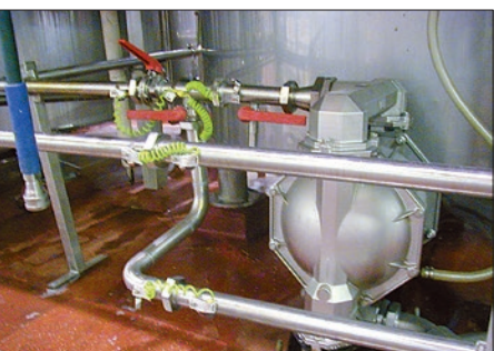
Bomba sanitária de 3" usada para transferir a base cosmética de xampus
