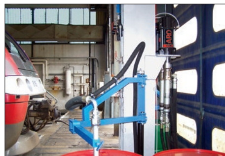
Bombas de pistão de 2 esferas proporção de 9:1, usadas em um processo personalizado de lubrificação
